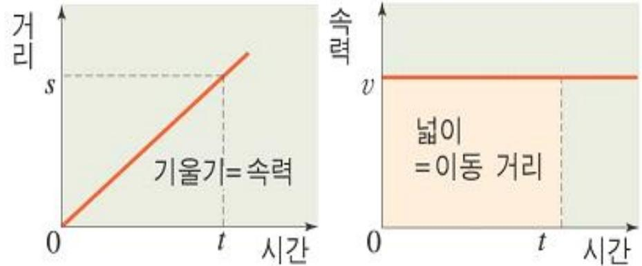
미분(변화율) : 속력 =  $v = \frac{s}{t} = \text{거리/시간}$  : 나누기      기울기=높이/밑변
